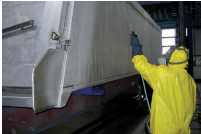
W trakcie procesu natryskiwania, w miejscu kontaktu z cieczą trawiącą powierzchnia aluminium natychmiast rozjaśnia się.
