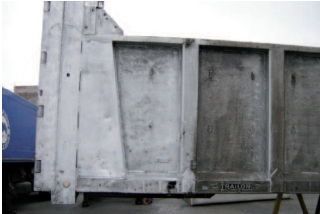
Naczepa do renowacji – z lewej strony powierzchnia po trawieniu, z prawej powierzchnia zanieczyszczona przed renowacją.
