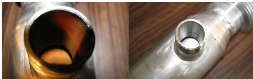
Realizacja usług derougingu – przed i po obróbce chemicznej
