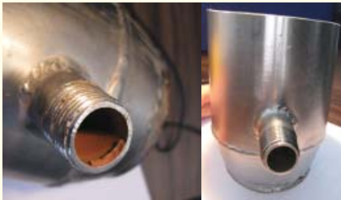
Ilustracja 3 : Próbka dostarczona przez producenta czekłady przed i po poddaniu odtlenianiu, usuwaniu korozji i pasywacji
